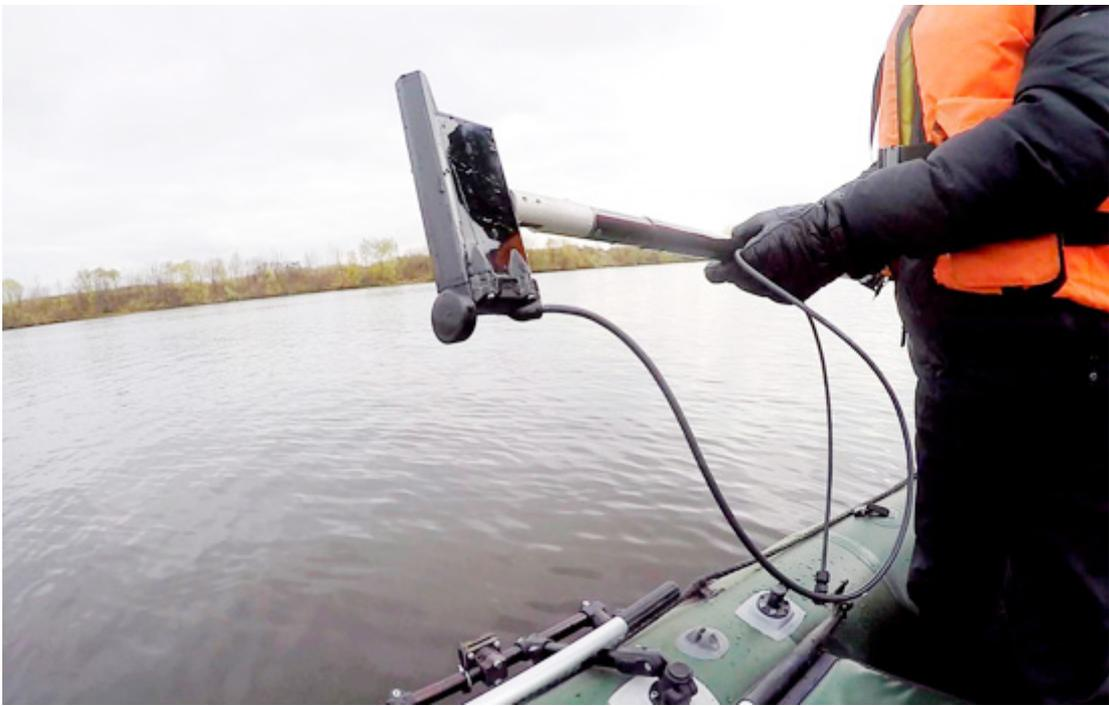
**Рисунок 6. Крепление с помощью KIT006**
