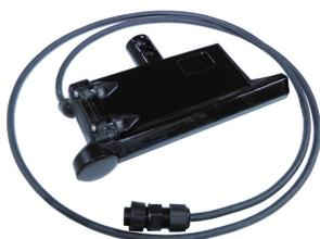
H5se7 - ультракомпактный гидролокатор бокового обзора со встроенным промерным эхолотом (ГБОЭ) на бортного размещения сверхвысокого разрешения серии Гидра™. Рабочие частоты 700 кГц (ГБО) и 1000 кГц (эхолот, Эл) позволяют работать на глубинах до 30м. Предназначен для обзорного обследования акваторий, поисковых и промерных работ.
