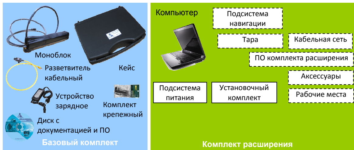
Рисунок 2. Структурная схема системы
