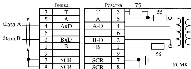
Рисунок 25. Подключение к ответвителю, содержащему защитные резисторы
