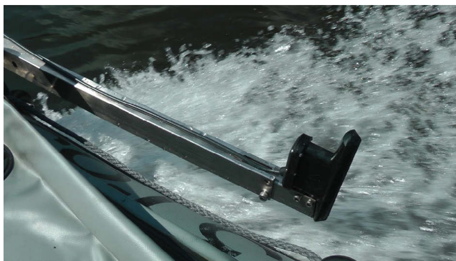
Рисунок 4. Установка Н5s7 на штанге 50x25мм (походное положение)
