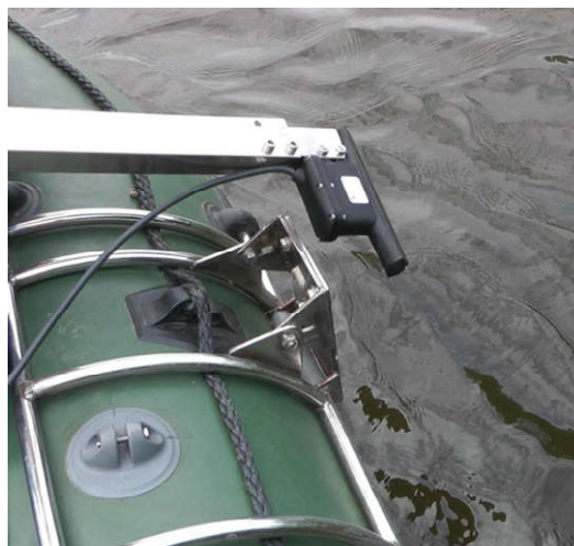
Рисунок 3. Установка Н5s7 на штанге 50x25мм
