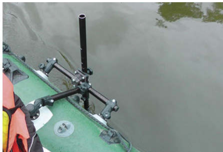
Рисунок 1. Установка H5s7 на лодке с борта с помощью трубчатого крепления KIT006 (рабочее положение)
