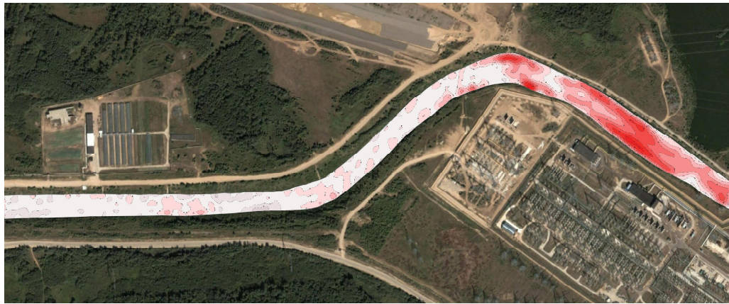
Рисунок 2. Пример результатов батиметрической съемки канала, выполненной с помощью ИГБО (совмещение батиметрической карты отклонений от проектных отметок с космоснимком)
