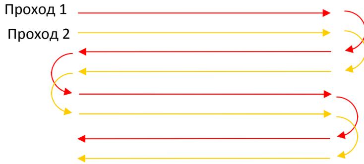
Ниже приведен пример выполнения двух независимых съемок с ортогональным направлением галсов. Это позволяет выполнить “освещение” дна с двух взаимно-перпендикулярных направлений.
