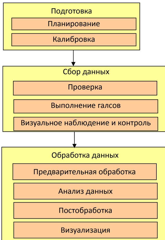
Рисунок 7. Процесс выполнения съемки ГБО
