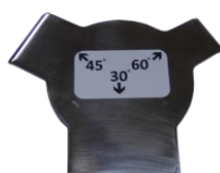
Шаблон для установки угла наклона антенн ГБО.
