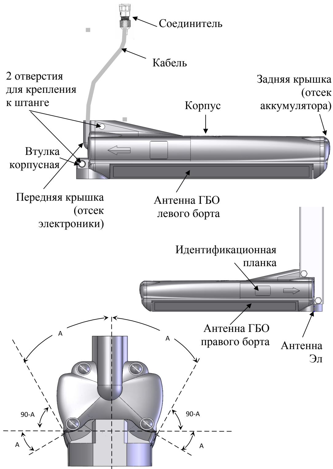
Рисунок 1. Конструкция моноблока
