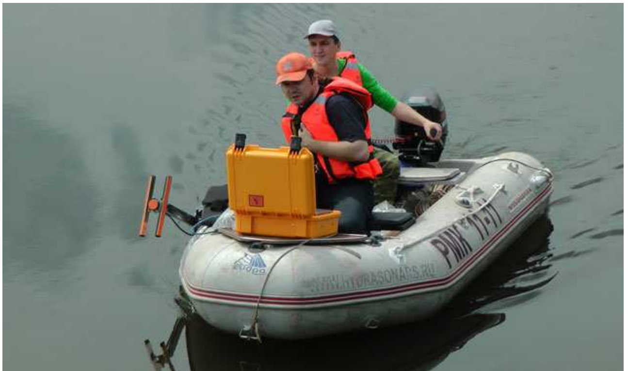
Рисунок 18. Размещение комплекса версии Prof (ГБОЭ, модель H4s3) с использованием установочного комплекта KIT001 на лодке 290см (блок антенн в походном положении)
