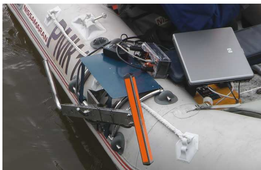
Рисунок 6. Размещение комплекса версии Light (ГБО, модель H4L3) с использованием установочного комплекта KIT001 на лодке 290 см (БА в походном положении)
