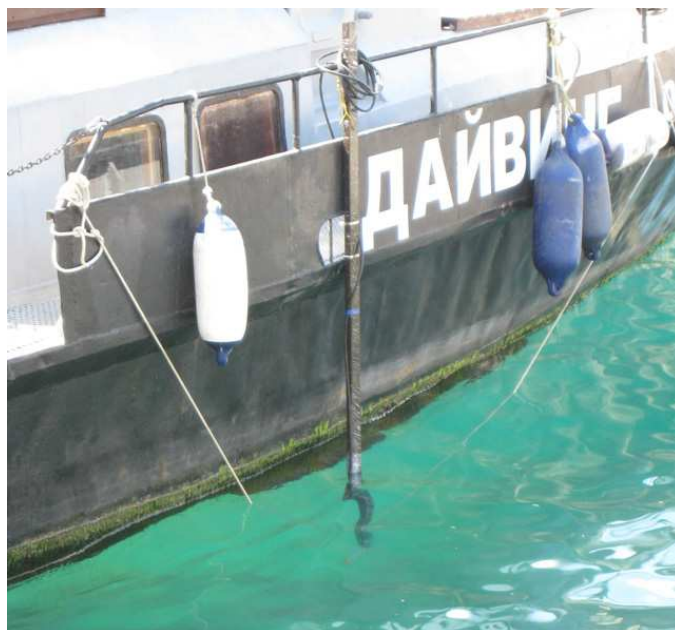
Рисунок 25. Установка штанги (L=3м) БА комплекса версии Light (ГБО, модель H4L3) при размещении на катере типа "Адмиралец" (БА в рабочем положении)
