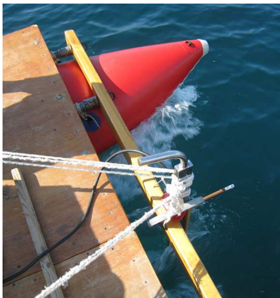
Рисунок 19. Крепление БА комплекса версии Light (ГБО, модель H4L3) на надувном катамаране (БА в рабочем положении)
