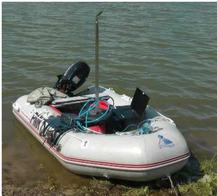
Рисунок 14. Размещение комплекса версии Prof (ППФ, модель Н4р) с использованием установочного комплекта KIT001 на лодке 290 см
