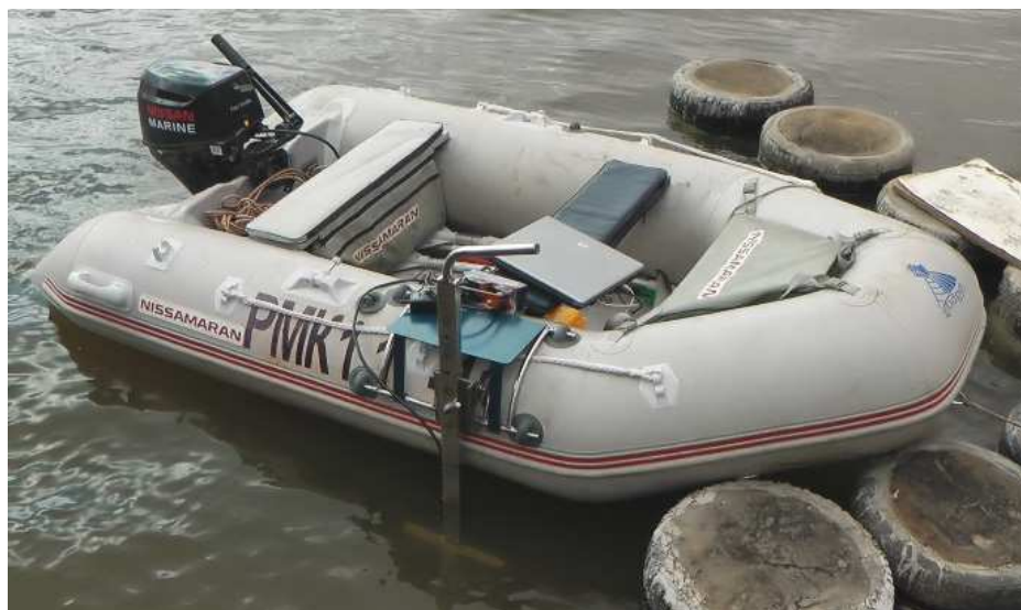
Рисунок 5. Размещение комплекса версии Light (ГБО, модель H4L3) с использованием установочного комплекта KIT001 на лодке 290 см (БА в рабочем положении)
