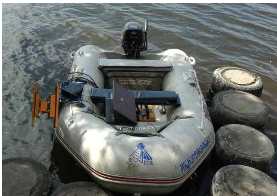
Рисунок 12. Размещение комплекса версии Prof (ИГБО, модель H4i3) с использованием установочного комплекта KIT001 на лодке 290 см (БА в походном положении)
