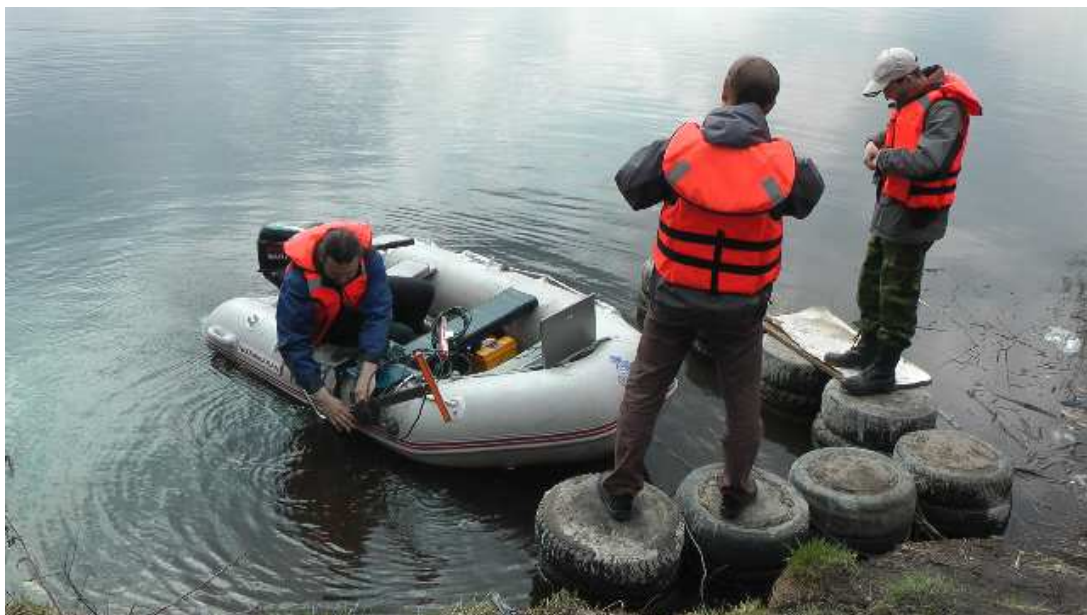
Рисунок 9. Размещение комплекса версии Light (ГБО, модель H4L3) с использованием установочного комплекта KIT001 на лодке 290 см (БА в походном положении)
