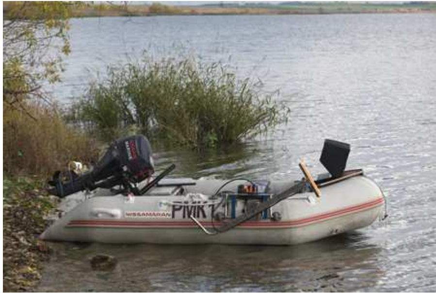
Рисунок 7. Размещение комплекса версии Light (ГБО, модель H4L3) с использованием установочного комплекта KIT001 на лодке 290 см (БА в походном положении)
