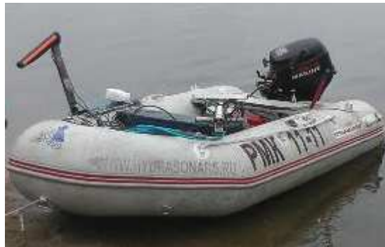
Рисунок 8. Размещение комплекса версии Light (ГБО, модель H4LM3) с использованием установочного комплекта KIT001 на лодке 290 см (моноблок в походном положении)
