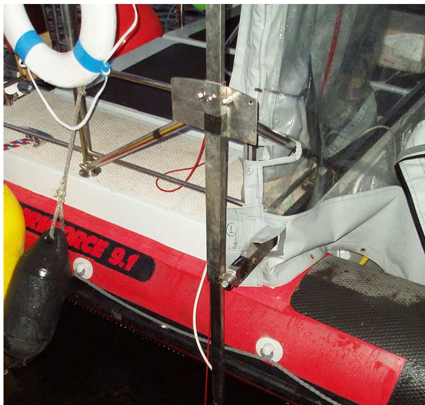
Рисунок 26. Установка штанги при размещении на катере (БА в рабочем положении)
