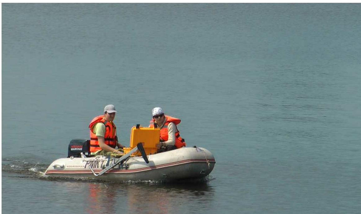
Рисунок 16. Размещение комплекса версии Light (ГБО, моноблок, модель H4LM3) с использованием установочного комплекта KIT001 на лодке 290 см (моноблок в походном положении)
