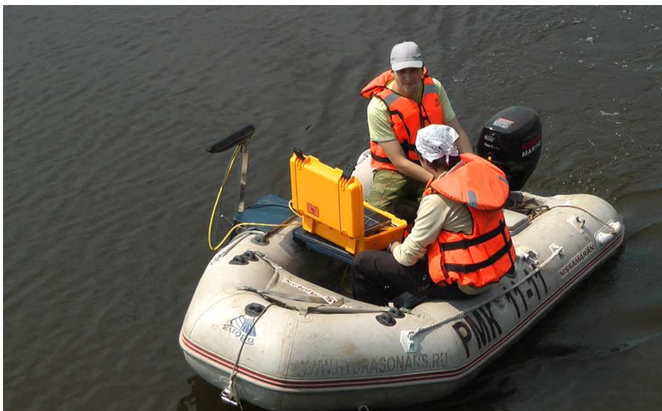
Рисунок 15. Размещение комплекса версии Light (ГБО, моноблок, модель Н4LM3) с использованием установочного комплекта KIT001 на лодке 290 см (моноблок в походном положении)
