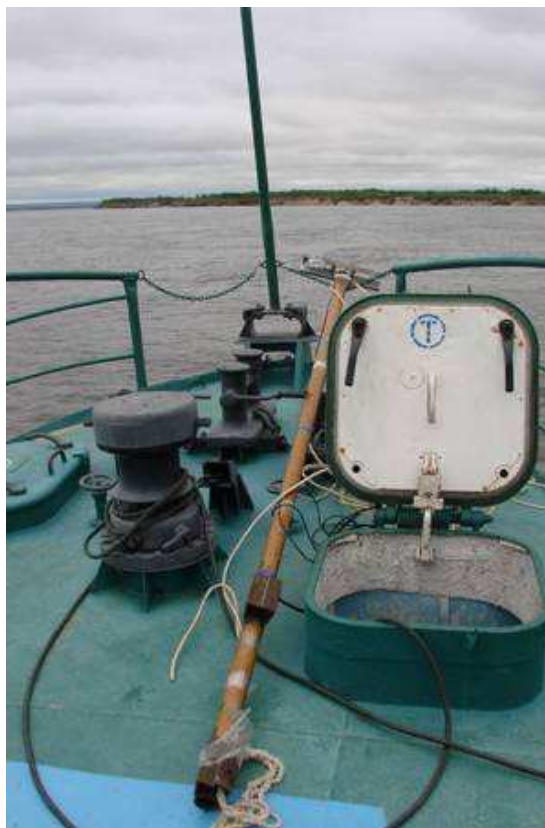
Рисунок 27. Штанга с БА комплекса версии Prof (ГБО, модель H4s3) для работы на судне типа "Ярославец"
