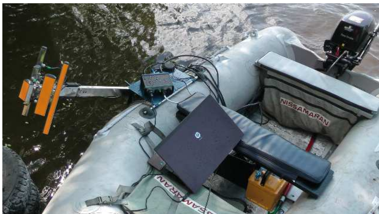
Рисунок 13. Размещение комплекса версии Prof (ИГБО, модель H4i3) с использованием установочного комплекта KIT001 на лодке 290 см (БА в походном положении)
