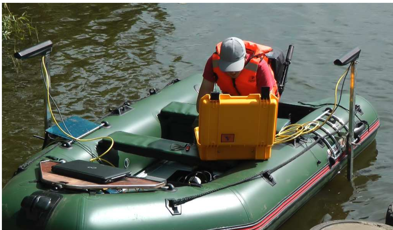
Рисунок 17. Размещение двух комплексов версии Light (ГБО, моноблок, модели H4LM3 и H4M7) с использованием установочного комплекта KIT001 на лодке 340 см (моноблоки в походном положении)
