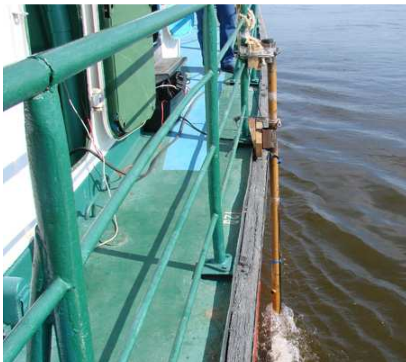
Рисунок 28. Крепление штанги с БА комплекса версии Prof (ГБО, модель H4s3) при работе на судне типа "Ярославец" (БА в рабочем положении)
