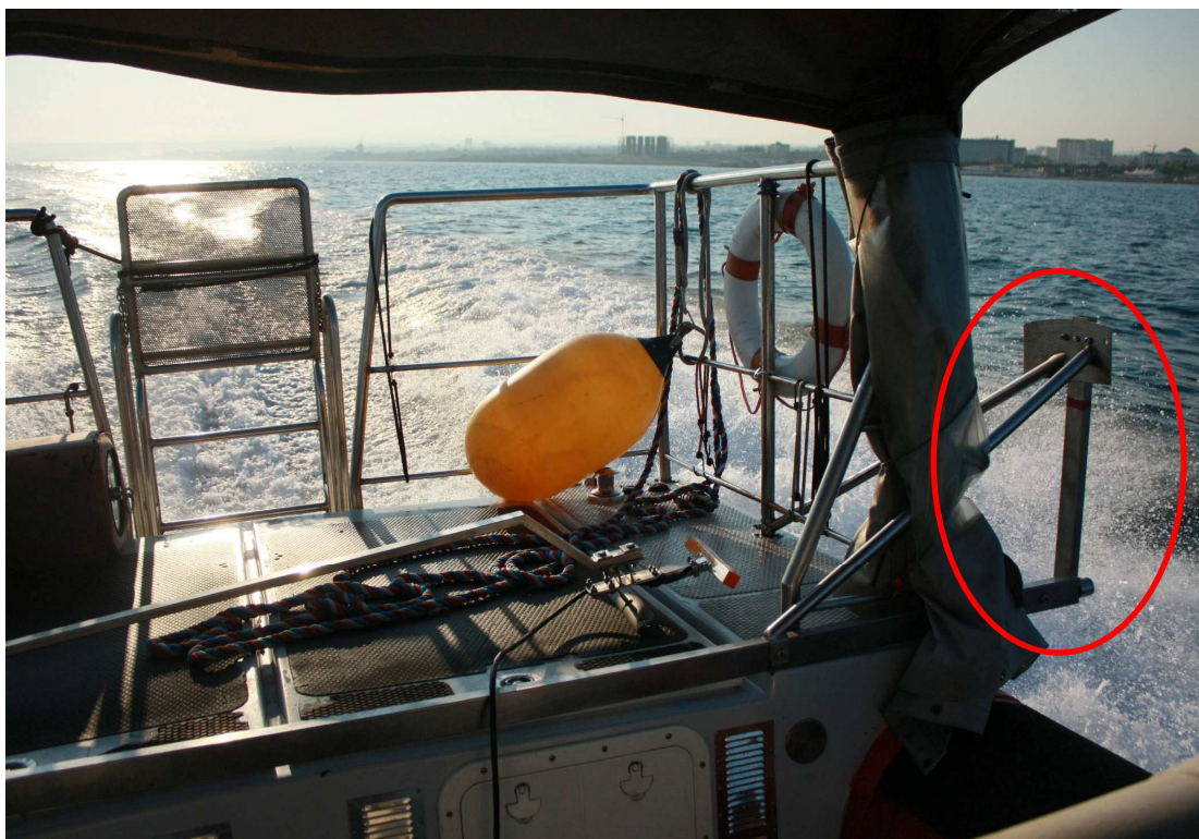
Рисунок 22. Кронштейн для крепления штанги БА комплекса версии Light (ГБО, модель Н4Л3) при размещении на катере
