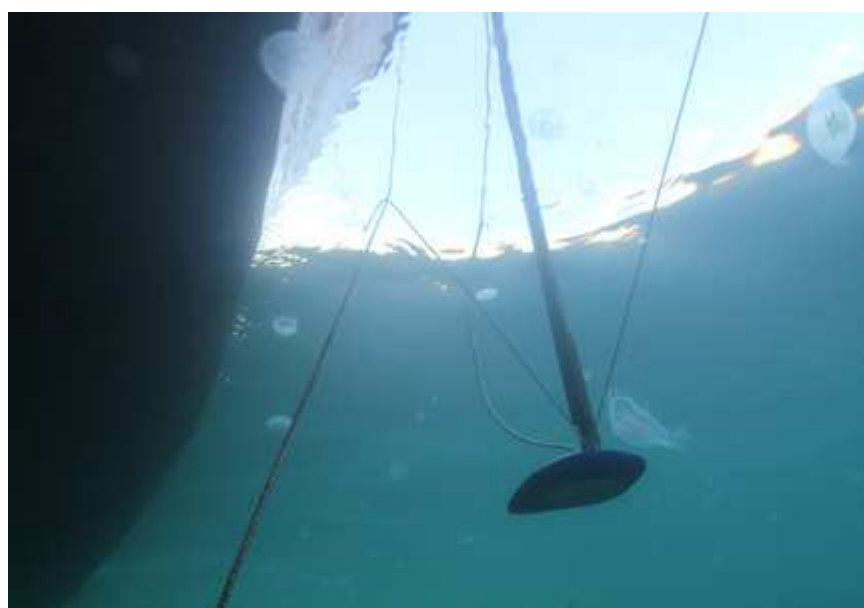
Рисунок 32. Крепление БА комплекса версии Prof (ППФ, модель H4p) на морском сейнере (БА в рабочем положении)
